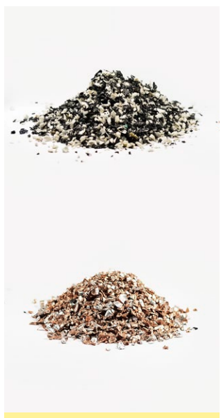
Aufbereiteter Kabelschrott Processed cable scrap
